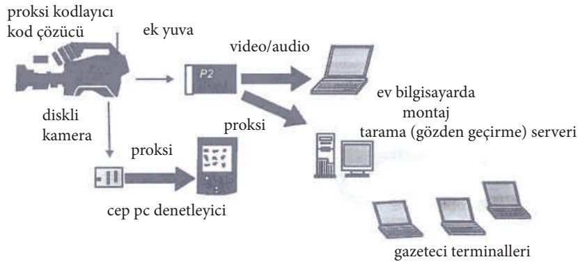
Şek.11.29: Post-prodüksiyon montajında P2 kartın yolu
