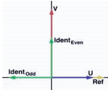
Şek. 4.32: SECAM-kodlayıcıda D_R ve D_B sinyalleri
