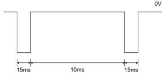
Şek. 6.11: Görüntü birimin A_1 ve A_2 anotlarının dürtü gerilimi
