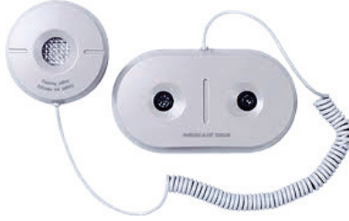
Şek.6.13: Ses üstü hareket sensörleri ve hareket algılayıcısı
