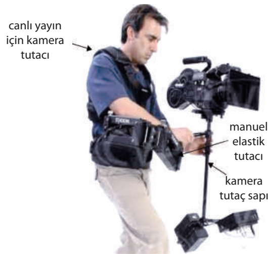
Şek.2.21: steadicam kameranın özel yerleşim şekli
