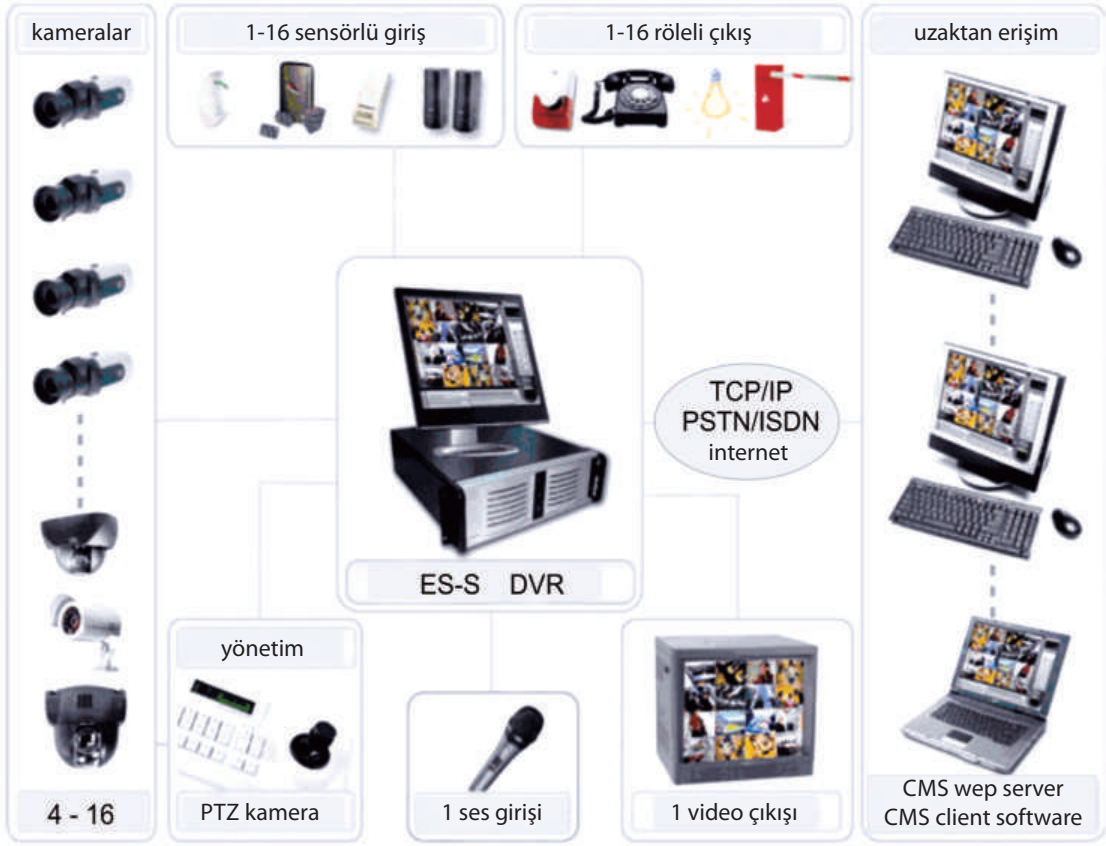
Şek.6.4: PC ve DVR ile IP video gözetim
